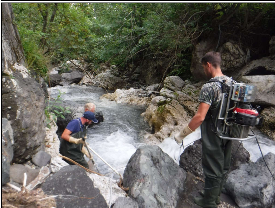
Figura 4.17 - Sopra: torrente Pettorina in località Malga Ciapela (ST_7) - foto verso monte Sotto: fase di campionamento ittico con elettrostorditore spallabile, agosto 2019
